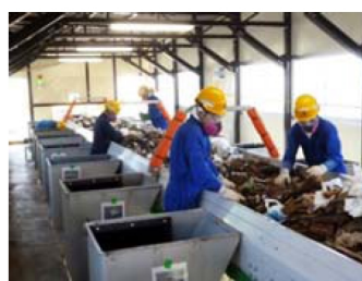
女川町二次仮置場・破碎・選別施設 手選別ライン
