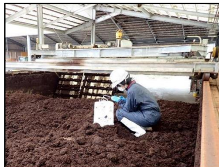
図2 クローズドチャンバー法によるガス採材の様子
