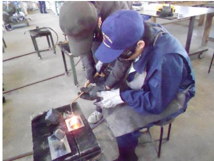
工業高校でのガス溶接実習
