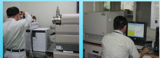
食品中の有害物質分析の様子 (液体クロマトグラフ質量分析計)
