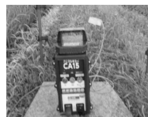
有害鳥獣駆除用電柵の設置
