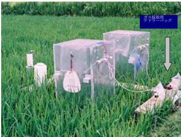
図2-4 温室効果ガス採取に用いた大型チャンバーと採取風景
