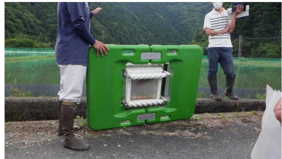
底のスクリューで泥をかき混ぜる
