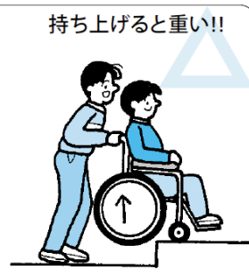
③ 後輪は無理に持ち上げずに、段差に沿ってタイヤの接地部を支点に半円を描くように後輪を押し上げます。
