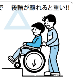
① ハンドグリップをしっかり握り、後輪を段に沿って下ろします。ハンドグリップを持ち上げながら下ろすとかなりの力が必要です。
