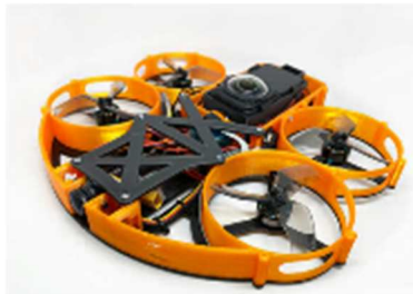
点検用ドローン
