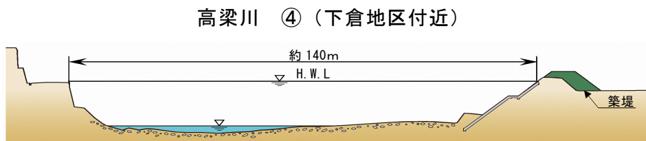
図-9 高梁川本川の代表断面図（宍粟地区から槻地区）
