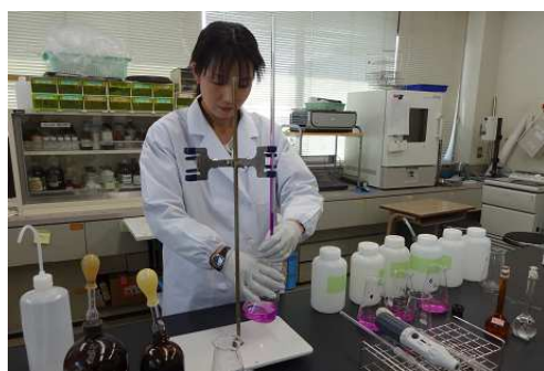
浴槽水の検査(滴定)
