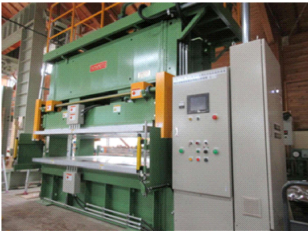
写真1 熱圧処理装置
