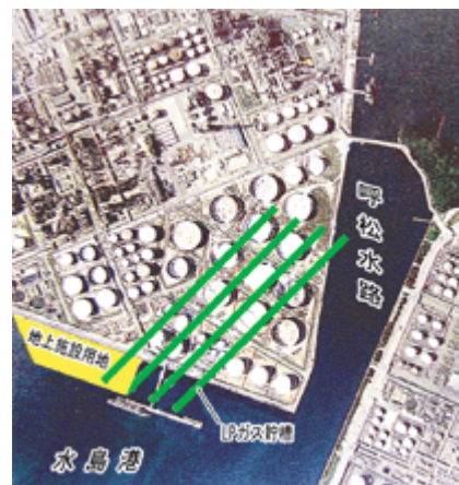
【写真説明】空から見たLPガス備蓄・倉敷基地の建設地 (4本線が地下貯蔵タンク) <山陽新聞社提供>
