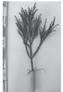
根の生長により陶器の筒が割れる
