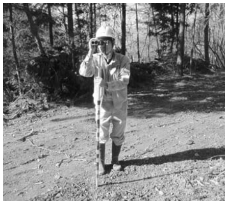
デジタルコンパスで間伐作業道の測量中
