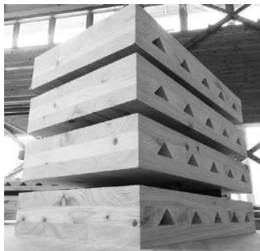
内層に空隙のあるCLT (試験用に穴を空けている)
