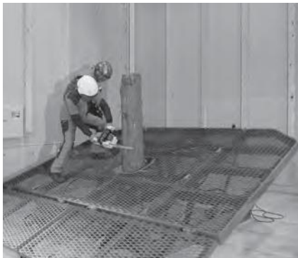
伐倒練習機を使用した技術指導の様子 (最大25°まで傾斜可能)
