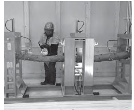
風倒木伐採装置(油圧で丸太に圧力をかけて風倒木の状態を再現)
