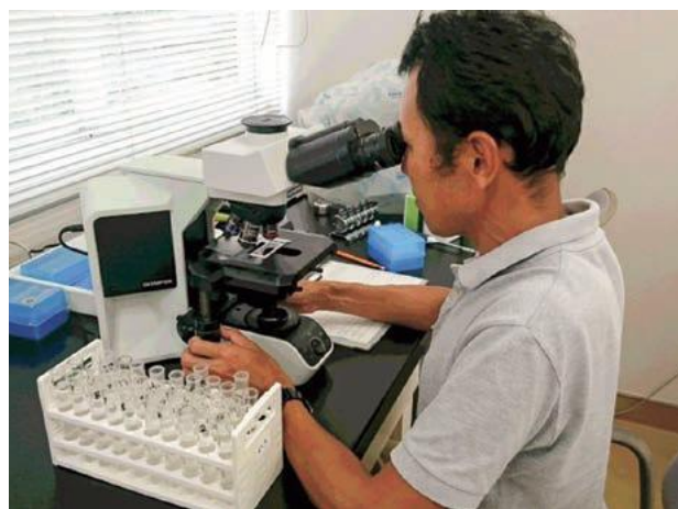
貝毒原因プランクトンの顕微鏡による検査
