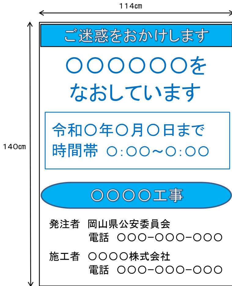
道路工事表示板(例)
