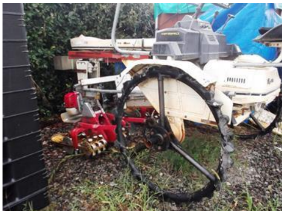
自作の除草機 (動力除草機を田植え機の左右に 2 台取り付け)
