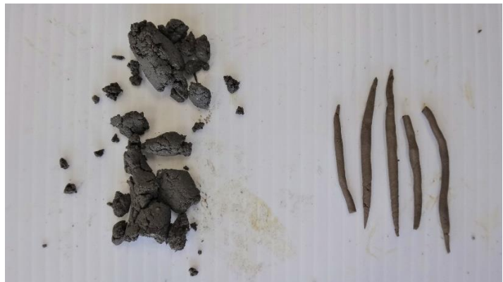
砂壤土の一例 埴土の一例 ※伸ばしても棒にならない ※伸ばすと 1 mm 程度より細くなる
