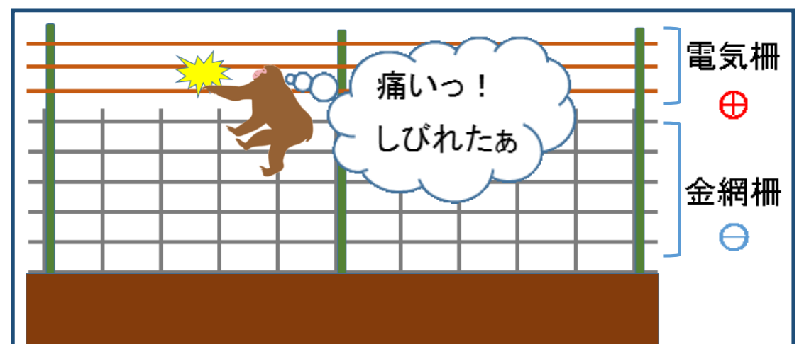
ニホンザルの侵入を 金網柵と電気柵を組み合わせた複合柵で防ぐ
