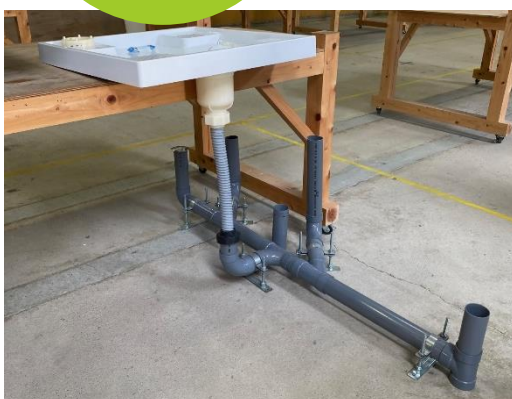
床排水配管実習(洗濯機置き場)
