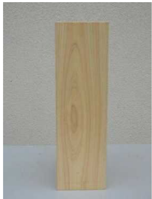
割れ・変色がない
