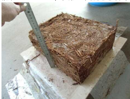
リンドウの栽培床として開発した チップの成型加工ボード
