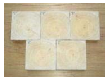
開発した複合乾燥による仕上がり (変色や内部割れが少ない)
