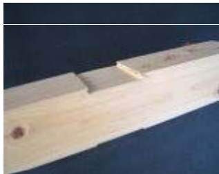
めり込み状況
