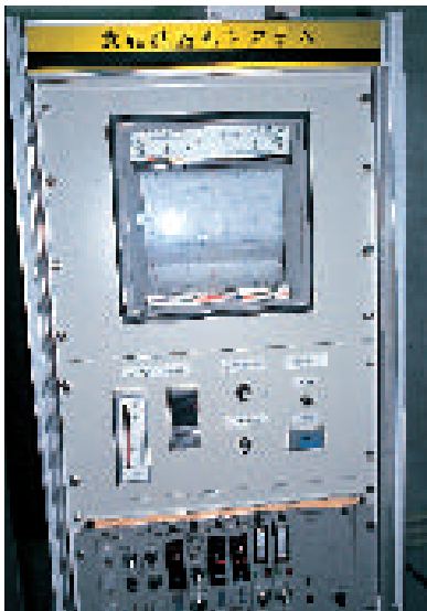
空間ガンマ線測定装置
