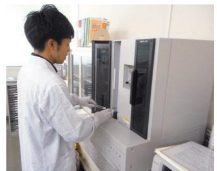
ラジウムを測定するアルファ線自動測定装置
