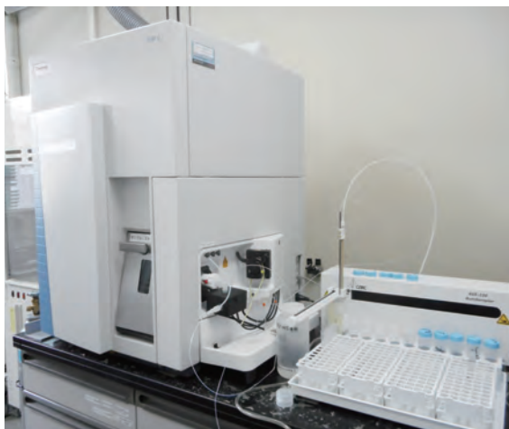
水中のウランを測定する 誘導結合プラズマ質量分析装置 (ICP-MS)
