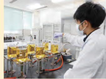
ラジウム分析の前処理作業
