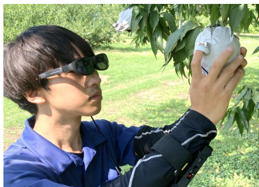
「果実硬度非破壊測定器」で果実袋の上から熟度を判定
