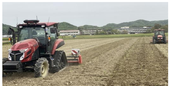
「ロボットトラクター(左)による協調作業の様子」
