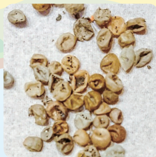
肥料成分が溶出した後の被膜殻
