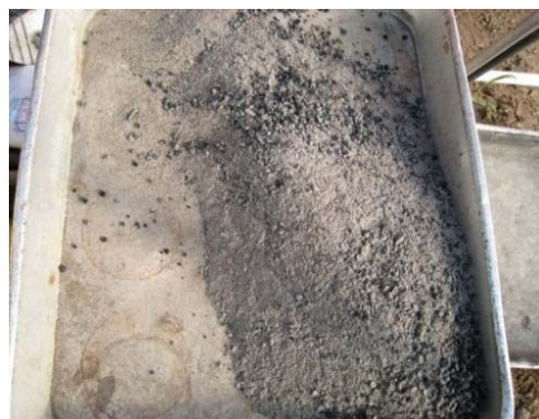
木質ペレットの燃焼灰
