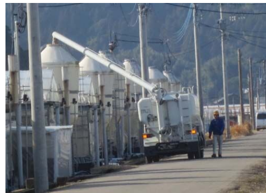
貯蔵タンクへの燃料の投入
